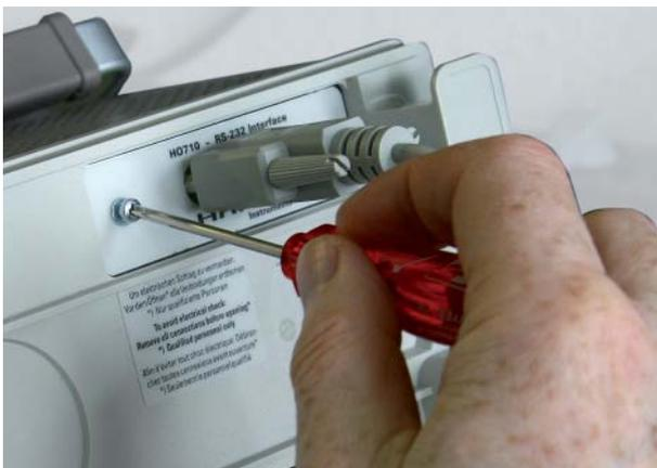
5.1.1 Entfernen Sie die beiden Befestigungsschrauben.
